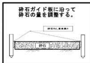
砕石均し状況
