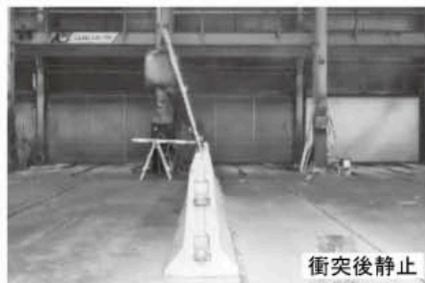
重錘衝突後の最大変形 (側面)
